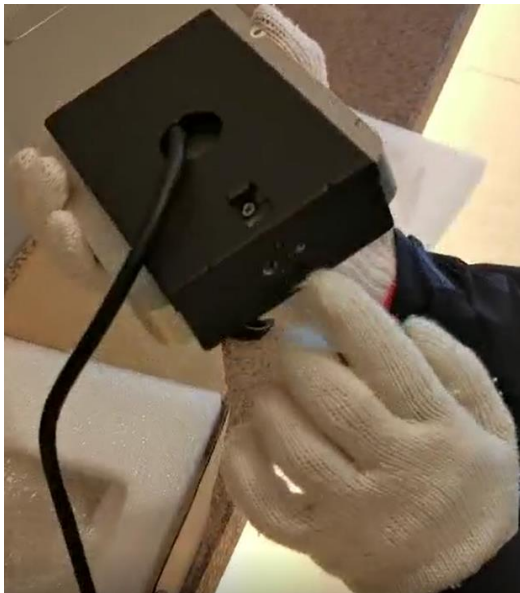
クイックシュー固定レバーを動かしてクイックシューを外します
